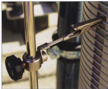
Bild 3: Ausführung des Spulenabgriffs mit Feststellschraube und Krokodilklemme
