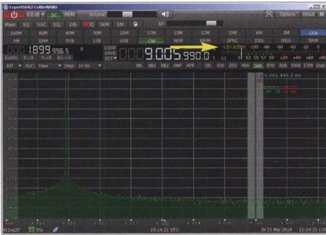
Bild 3: Messung des Seitenbandrauschens beim Colibri-Nano bei f_0 = 9 MHz und \Delta f = 6 kHz; ein Eingangssignal mit P_i = -12 dBm führt zum Anstieg des Grundrauschens um 3 dB. Das S-Meter zeigte ohne Signal -123 dBm an und nun -120 dBm (Pfeil).
