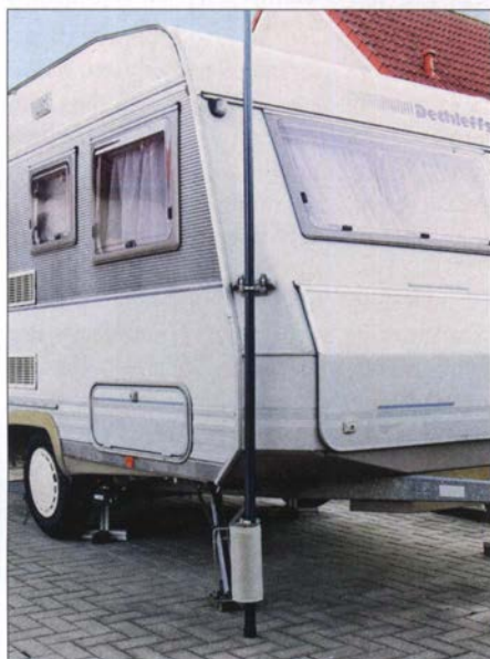
Bild 1: Betriebsbereite KW-Allbandantenne; am unteren Ende ist die Anpassungsspule gut zu erkennen.
