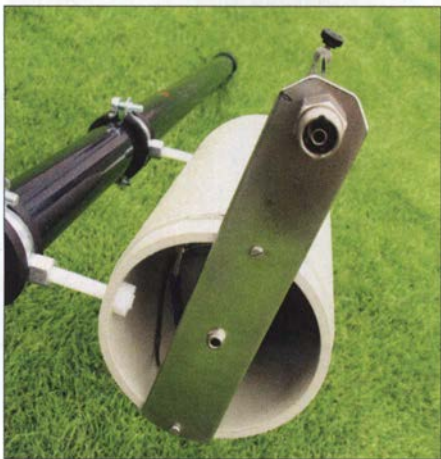
Bild 7: Unterer Teil der Antenne mit Koaxial-Steckverbinder und Erdungsbuchse
