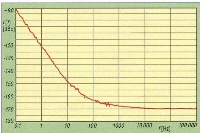
Bild 4: Anhand der Messwerte ermittelte Seitenbandrauschkurve des Colibri-Nano
