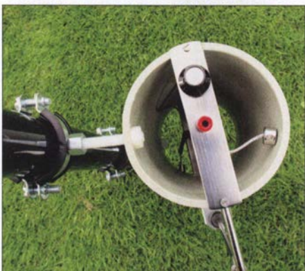
Bild 8: Oberer Teil der Spule mit Antennen- drahtanschluss und Drehkondensatorknopf
