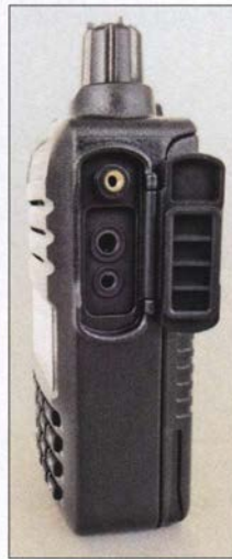
Zwei Klinkenbuchsen ermöglichen den Anschluss eines Headsets.
