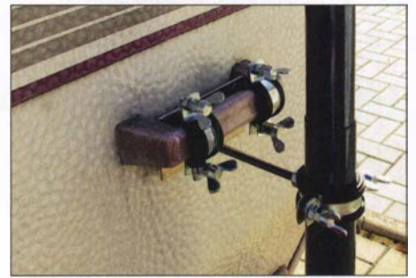
Bild 9: Fixierung des Antennenmastes am Wohnwagen
