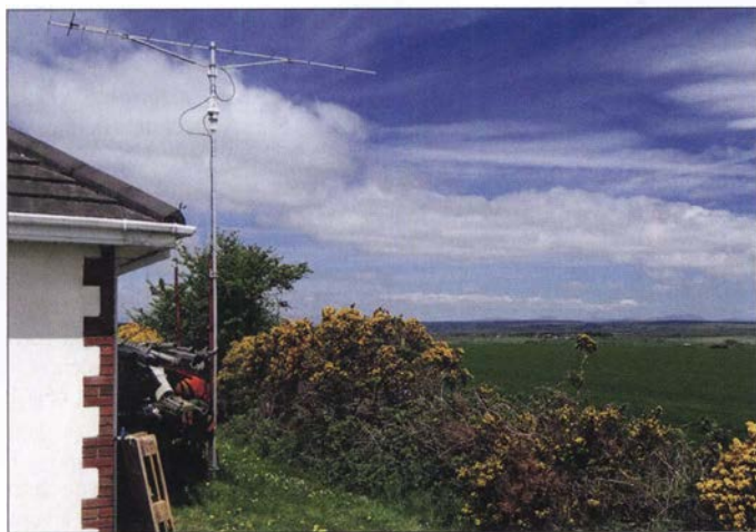
Nicht die Anzahl der Antennen zählt, sondern der Standort. EI3KD arbeitet „nur“ mit einer 11-Element-Tonna-Yagi Foto: EI3KD
