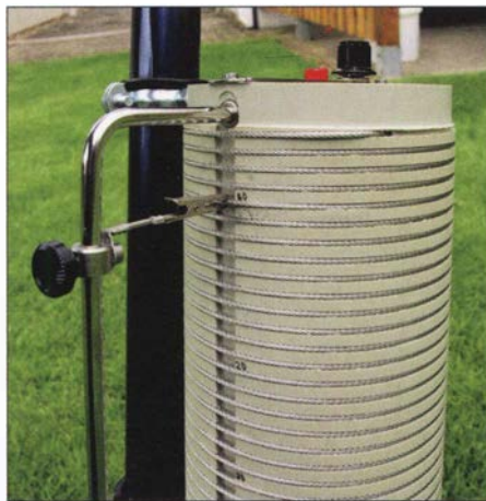
Bild 5: Spulenkörper mit gefräster Führung für die Drahtwindungen und Längsschlitz
