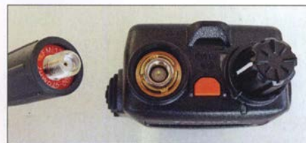
Die Antennenbuchse ist versenkt und wie heute üblich in Reverse-SMA-Norm ausgeführt.
